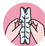
●接合状態をチェック（冷却後、シール部を左右に引っ張ってみる。剥がれれば加熱不足）
